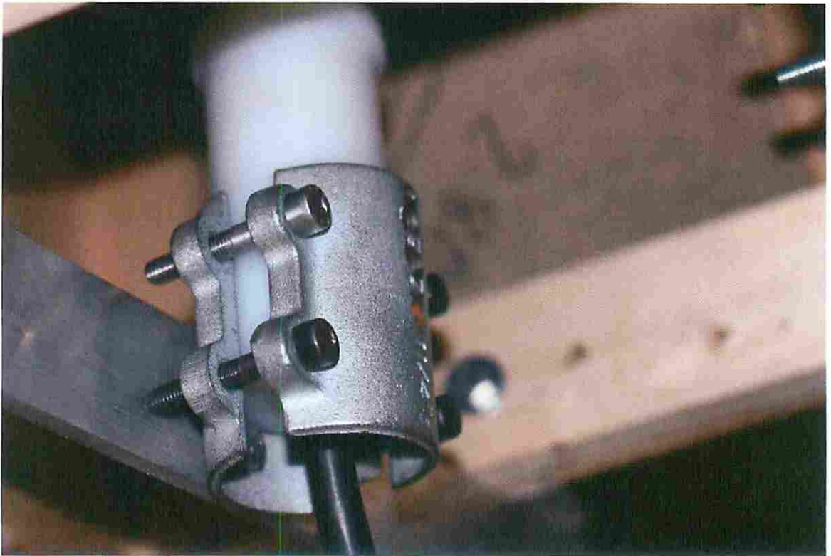
Figura 5. Detalle de la conexión inferior de la muestra de ensayo.
